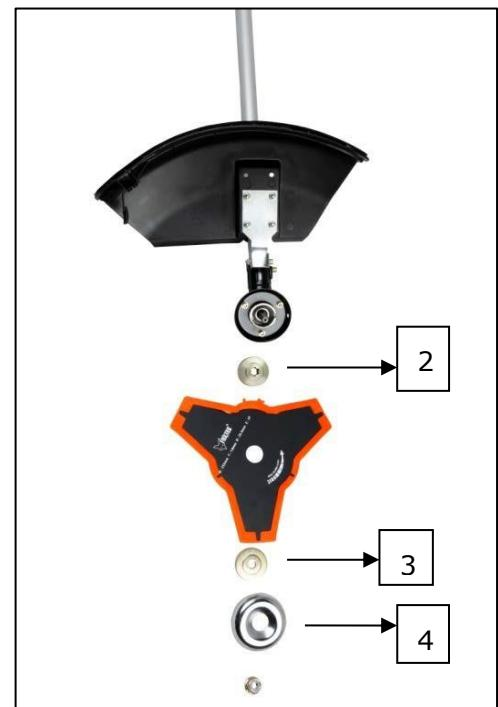
2. Entfernen Sie die Mutter, die Abdeckung (4) und die obere Abstandsscheibe (3) von der Getriebewelle
