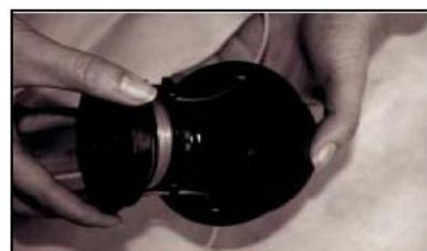
7. Führen Sie die Fadenenden durch die Löcher in des äußeren Spulenteils
