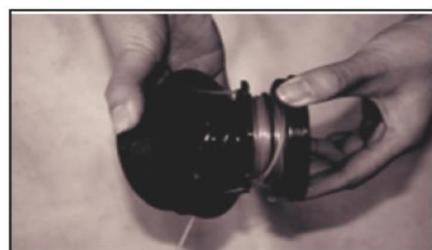
5. Entfernen Sie den überflüssigen Faden
