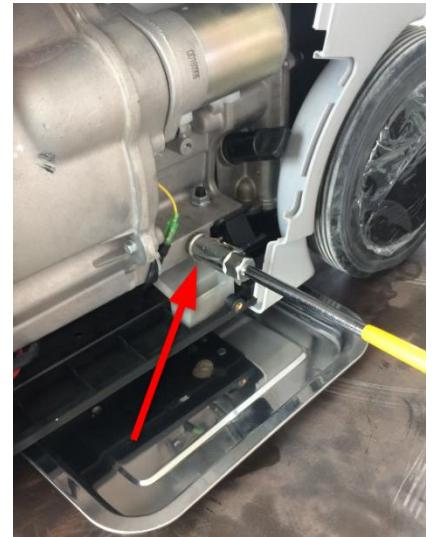
Ensuite, placez la machine sur une surface plane et démarrez le moteur. Si le niveau d'huile est suffisant, le témoin d'huile moteur n'est pas activé.
