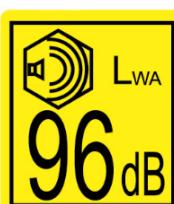
Garantiert Schalldruckpegel 96dB. Bitte möglichst Gehörschutz tragen.
