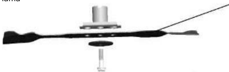
Rimettete tutto al suo posto come mostrato. Fissare la vite in modo corretto. La coppia di fissaggio è di 45Nm. Sostituire anche la vite della lama quando si sostituisce la lama.
