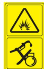
Kraftstoff ist entzündlich. Halten Sie die Maschine von offenem Feuer fern; Betanken Sie den Tank nicht bei laufendem Motor.
