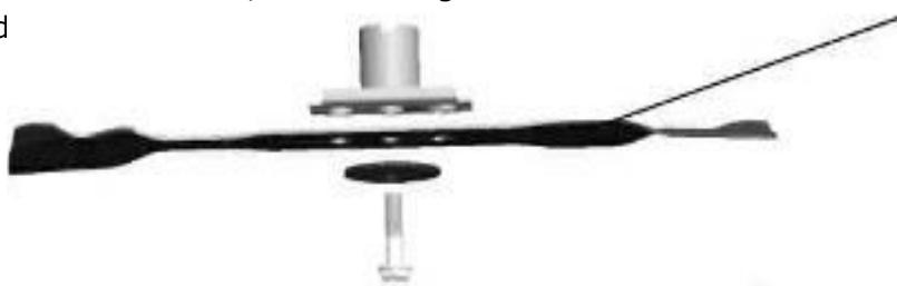
Setzen Sie wieder alles so ein wie abgebildet. Befestigen Sie die Schraube ordnungsgemäß. Befestigungsdrehkraft beträgt 45Nm. Ersetzen Sie auch die Schraube der Klinge, wenn Sie die Klinge ersetzen.
