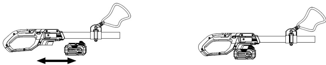
Abbildung 4: Installation des Akkus
