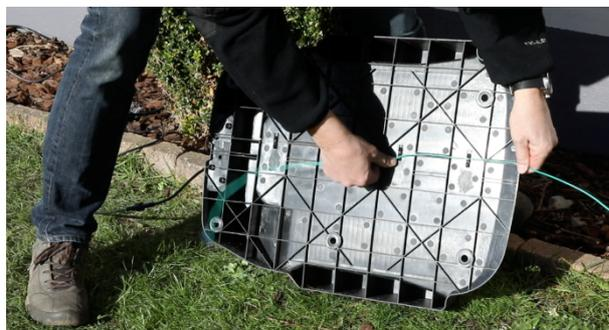
Después de conectar ambos extremos (IN y OUT), coloque la cubierta protectora
