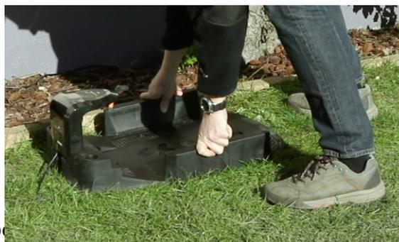
La estación de carga debe colocarse de forma que la flecha roja de la estación de carga debe apuntar en dirección a la zona de trabajo.
