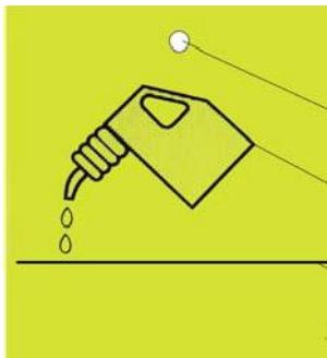
**DE ACHTUNG!** Öl für den Transport abgelassen. Vor dem Gebrauch 4-Takt Motoröl einfüllen. Bei Nichtbeachtung entsteht ein dauerhafter Schaden am Motor und setzt die Garantie außer Kraft!
