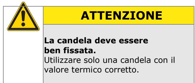
12. Ispezionare visivamente la candela. Se l'isolamento è danneggiato, sostituire la candela. Se la candela usata deve essere usata di nuovo, pulirla con una spazzola.
