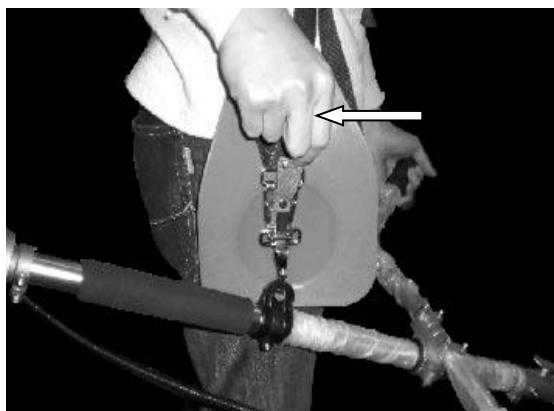
Der Schultergurt ist mit einer Schnelllöse-einrichtung (siehe Bild) ausgestattet. Sie können den Schultergurt schnell entfernen, indem Sie an der Schnelllöseeinrichtung ziehen.
