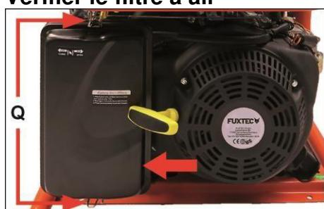
Desserrez les sangles de serrage (Q) en haut et en bas du boîtier du filtre à air.
