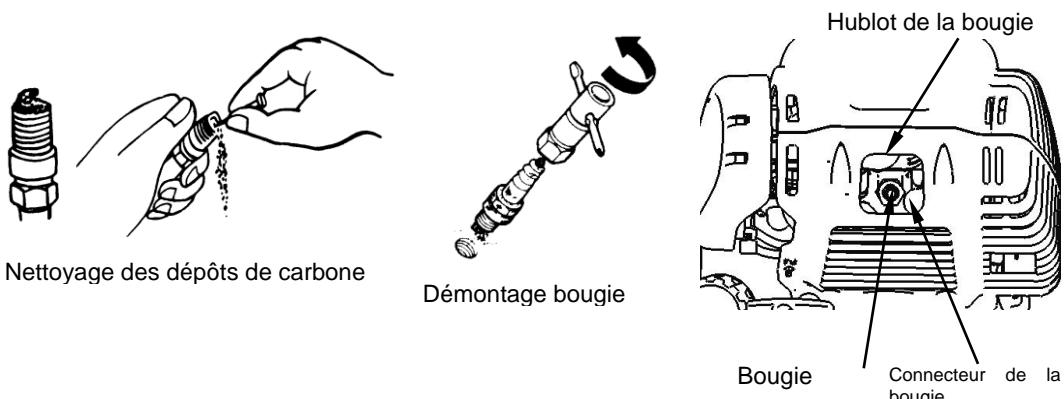
4. Vérifiez l'écart avec une jauge d'épaisseur et pliez l'électrode à la bonne distance de 0,6 à 0,7 mm
