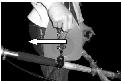
Der Schultergurt ist mit einer Schnelllöseeinrichtung (siehe Bild) ausgestattet. Sie können den Schultergurt schnell entfernen, indem Sie an der Schnelllöseeinrichtung ziehen.
