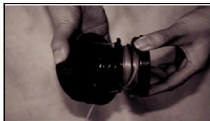
5. Entfernen Sie den überflüssigen Faden.
