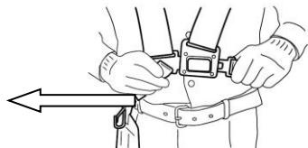
La sangle d'épaule est équipée d'un dispositif de dégagement rapide (voir photo). Vous pouvez retirer rapidement la bandoulière en tirant sur la fermeture rapide.
