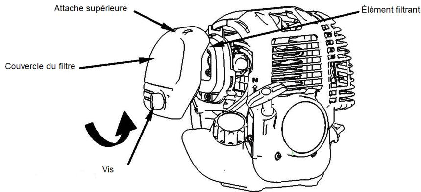
2. Utilisez des solvants non inflammables ou des agents de nettoyage à point d'éclair élevé pour nettoyer l'élément filtrant et laissez-le sécher complètement.
