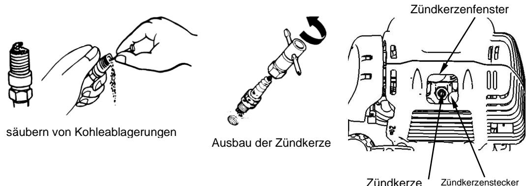
4 Überprüfen Sie den Spalt mit einer Fühlerlehre und biegen die Elektrode auf den richtigen Abstand von 0,6 bis 0,7mm
