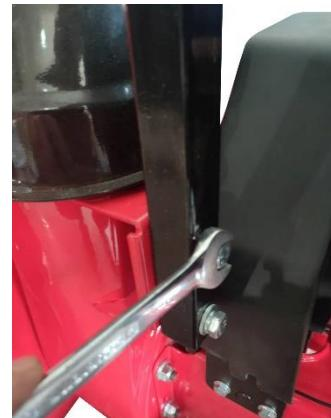
12. Montare ora la parte superiore della barra di regolazione dello scivolo di scarico. Per eseguire tale operazione, far scorrere la barra attraverso l'anello in gomma.
