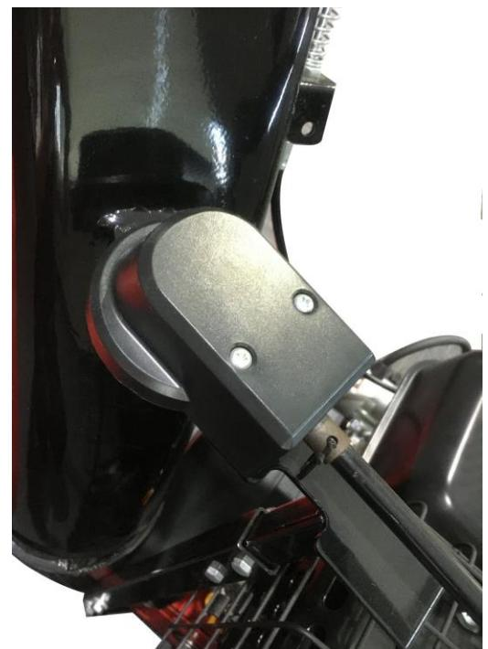
4. Installieren Sie die Stützstange des Schneeschachtes und sichern Sie die Mutter mit einem Schraubenschlüssel.
