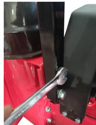
5. Montieren Sie nun den oberen Teil der Verstellstange des Auswurfschachtes. Dazu schieben Sie diese durch den Gummiring.,
