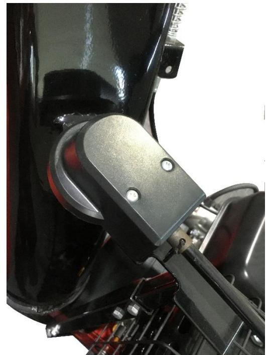
11. Installare l'asta di supporto dello scivolo di scarico e fissare il dado con una chiave inglese.
