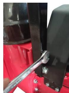
5. Montez maintenant la partie supérieure de la tige de réglage de la goulotte d'éjection. Pour ce faire, il faut le pousser à travers l'anneau de caoutchouc.
