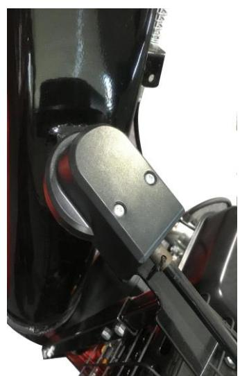
4. Installez la tige de support du réceptacle à neige et fixez l'écrou à l'aide d'une clé à molette.
