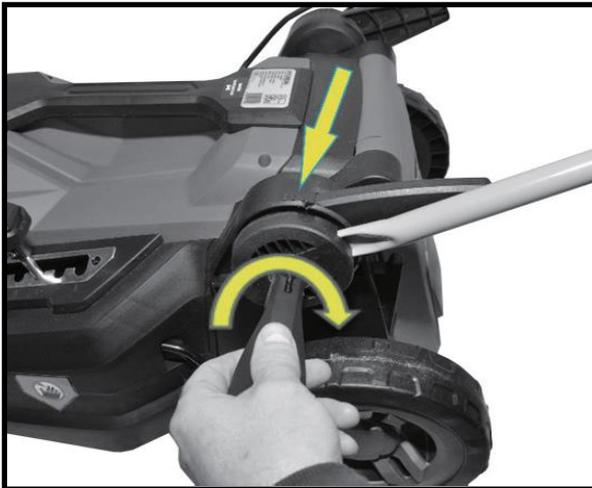
Führen Sie den Schnellspanner durch die Öffnung am unteren Holm. Im Anschluss verbinden Sie den Holm mit dem Mäher wie abgebildet und schließen den Schnellspanner zur Fixierung des Holms am Mäher.
