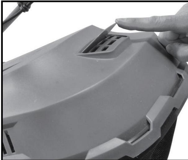
Der Grasfangkorb ist mit einer Füllstandsanzeige ausgerüstet. Während des Betriebes des Mähers, strömt Luft durch die Öffnung und hebt die Klappe an. Sobald der Korb voll ist, gelangt keine Luft mehr durch die Öffnung und die Klappe schließt sich.
