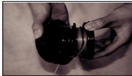
5. Entfernen Sie den überflüssigen Faden.
