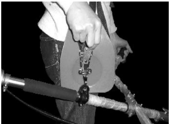
La sangle de transport est équipée d'un dispositif de dégagement rapide (voir photo). Vous pouvez retirer rapidement la sangle de transport en tirant sur la fermeture rapide.
