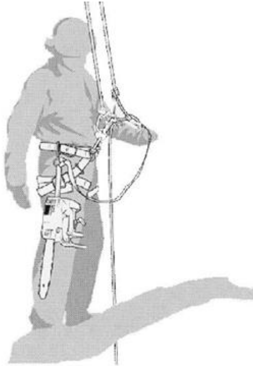
Figure A.1 - Exemple pour la fixation d'une tronçonneuse pour l'entretien d'arbres, à la ceinture de l'utilisateur
