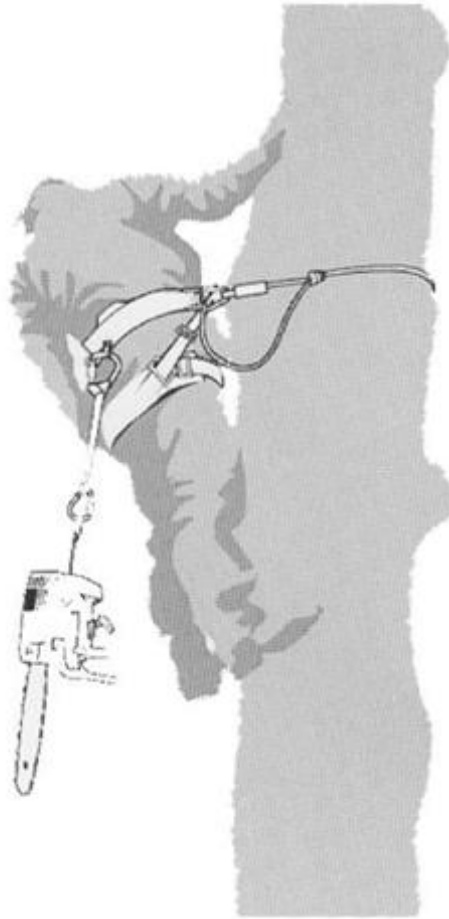
Figure A.2 - Exemple pour la fixation d'une tronçonneuse pour l'entretien d'arbres au point central arrière de la sangle de portage
