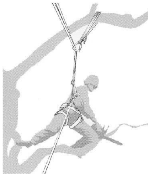
Bild A.3 — Beispiel für eine Umlenkung des Hauptseils über eine zusätzliche Aufhängevorrichtung
